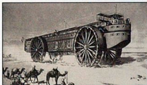
173 Le « Vaisseau du désert », super-véhicule de 40 m de long et de 13,50 m de haut, imaginé par des ingénieurs allemands en 1928. Il était susceptible de transporter 200 tonnes de marchandises et 150 voyageurs à travers le Sahara, avec le confort d'un paquebot transocéanique
