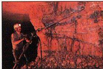
315 Mineur travaillant au marteau piqueur dans une galerie
